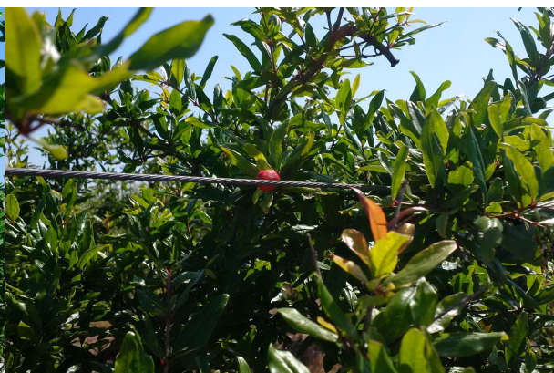
Toron en acier galvanisé 1 x 7 Ø 3,00 mmt
