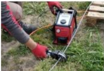
Taglio della fune o del cavo in campo
